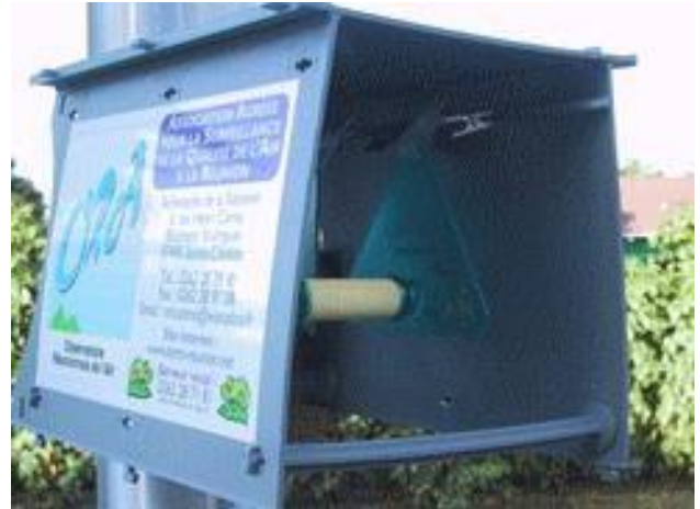
Figure 13 : Tubes passifs (Radiello) dans leur abri - Source : site internet d'Atmo Réunion
