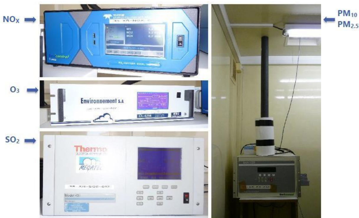
Figure 11 : Appareils de mesures utilisés par Atmo Réunion - Source Atmo réunion (RE PRE 22 005 A diffusé le 13/05/22)
