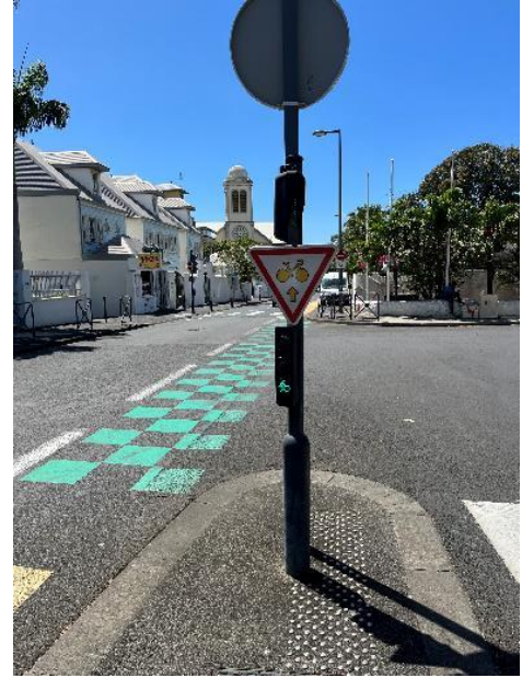
Figure 15 - Exemple de marquage damier au franchissement d'une ligne de feu, d'un feu cycle et d'un panneau M12 - Ingérop Saint-Denis 2021
