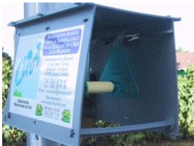
Figure 21: Tubes passifs (Radiello) dans leur abri - Source : site internet d'Atmo Réunion
