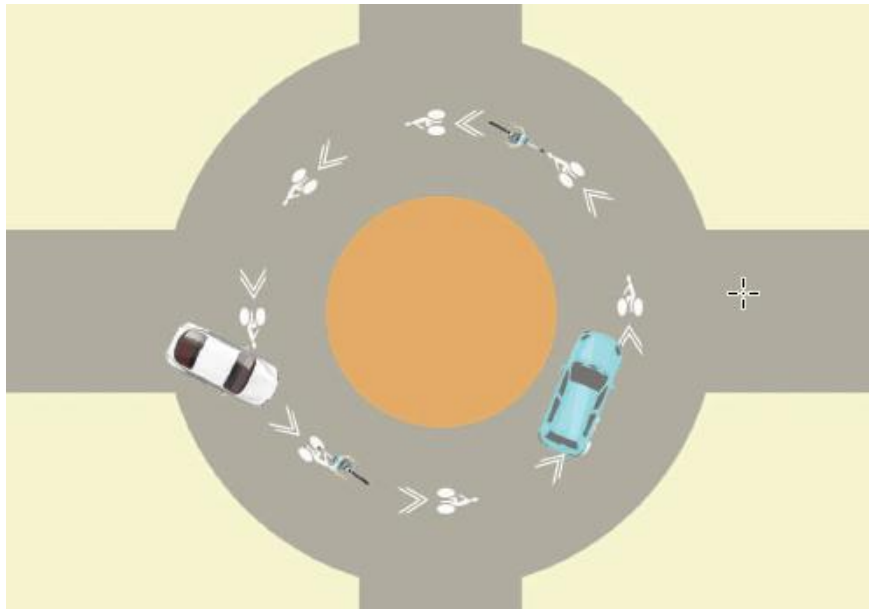
Figure 23 - Principe de marquage dans l'anneau - Cerema Fiche plan d'actions pour les mobilités actives - Cerema 2021
