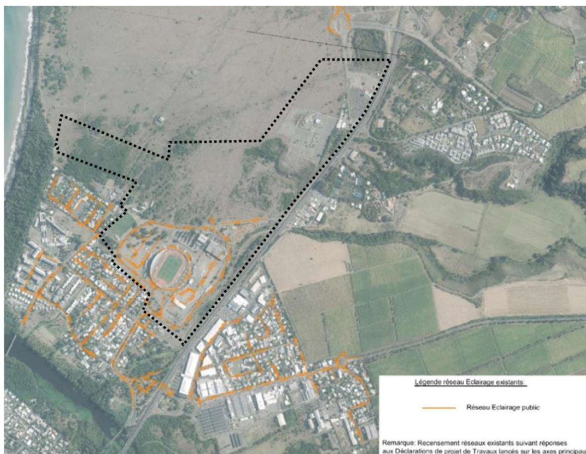
Figure 97 : Plan du récolement du réseau d'éclairage public
