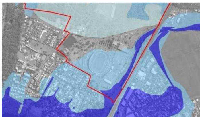
Cette zone se situe ainsi en aléa moyen et fort du PPR Inondation, ce qui réglemente les critères de constructibilité sur cette zone. Les travaux de prolongement de l'axe mixte permettront de recalibrer le lit aval de la ravine la Plaine et de réduire le risque inondation sur le
