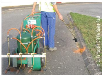
Une flamme issue de la combustion d'un gaz, appliquée à plus de 1000°C sur la végétation permet de la détruire. Le stade idéal pour intervenir est de 2 à 3 feuilles. Si les plantes sont plus développées, il faudra augmenter le temps d'application au niveau du collet des plantes.
