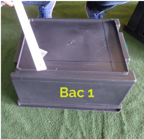
**2-** Percer plusieurs trous de 8 mm de diamètre sur le fond du bac 1
