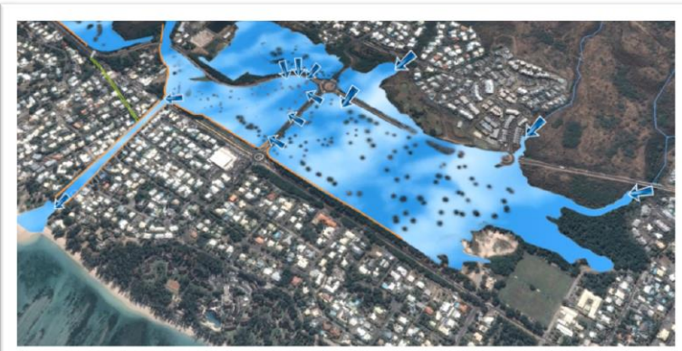
Après construction des digues et recalibrage
