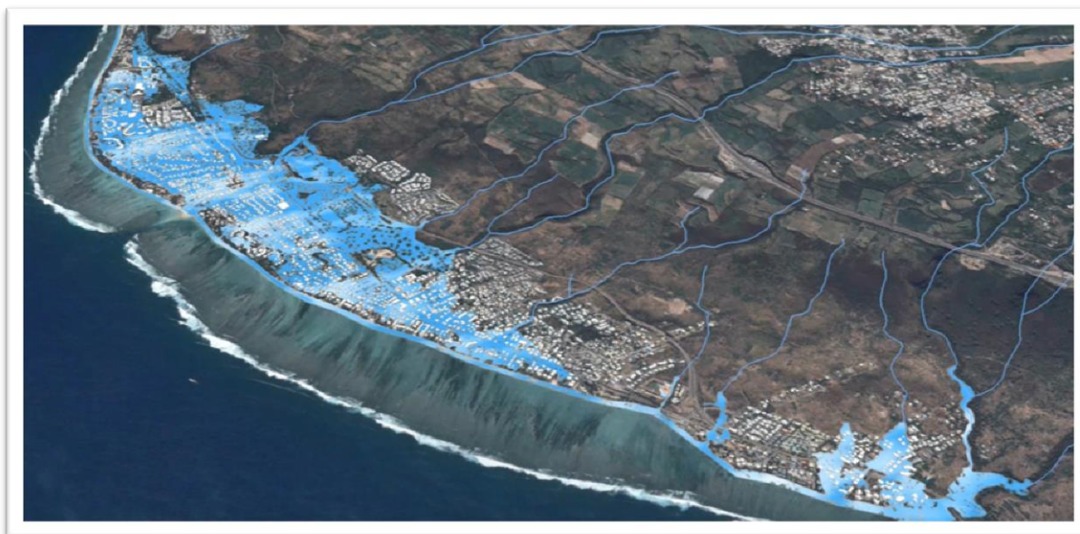
Inondation sur le secteur de l'Hermitage La Saline les Bains par 15 ravines (crue centennale), avant travaux.
