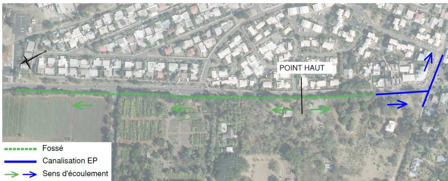
Figure 27. Réseau d'eaux pluviales existant sur le périmètre d'étude
